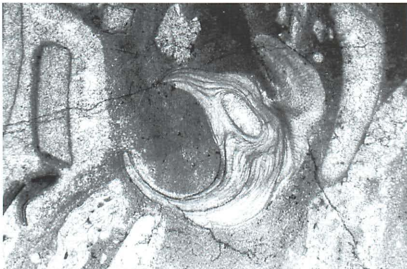
Abb. 33 Zweischaler Packstone mit Brachiopoden- (Mitte) und Muschelschalen (rechts und links außen), das Bindemittel ist Mikrit (dunkel, Mitte, rechts und unten) und lokal Sparit (hell, links um Muschelschale). DS 97/5, Bildbreite 5,2 mm, PPL. Tal am S-Rand der Knâzeskaâ-Wiese, 1880 m ü. HN (Foto: O. Tietz).
