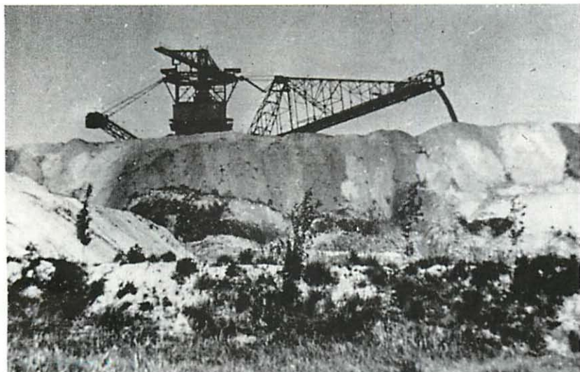
Abb. 1. Hochabsetzer bei der Schlufverkipfung auf der Außenhalde Deutsch-Ossig Nord im Bereich des Tagebaues Berzdorf. Auf der Halde sichtbare helle Massen sind vorwiegend pleistozänen, dunkle tertiären Ursprungs. (Aufnahme 1962).
