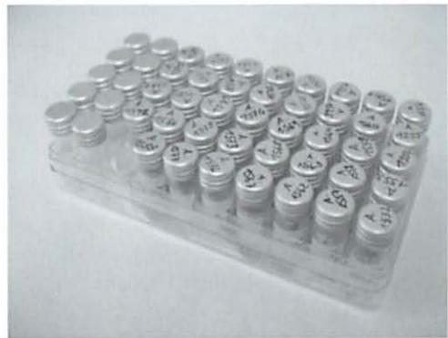
Abb. 6 Magazinkasten für Gewebeproben
