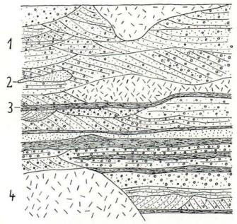
Abb. 2. Rhythmische Schichtung fluviatiler Sedimente (Basisschotter) in der Kiesgrube Stannewisch (Aufschluß 1); Ausschnittshöhe etwa 5 m. 1 — schräggeschichtete Kiese und kiesige Sande, 2 — Fein- und Mittelsand, 3 — Feinsand und Schluff, glimmrig, 4 — Schutt
