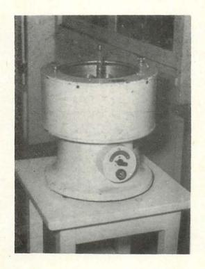
Abb. 2. Zentrifuge Type ZE-3 zur Untersuchung des Bodens auf Nematodenzysten
